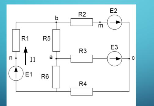
E1=20 V E2=15 V E3=50 V R1=10 Ohm R2=17 Ohm R3=25 Ohm R4=30 Ohm R5=50 Ohm R6=13 Ohm
