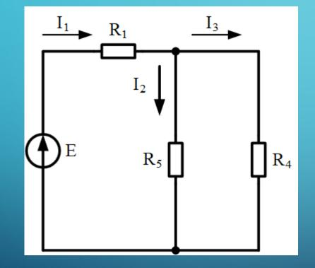
$=\frac{R_5\cdot R_4}{R_5+R_4}$  $R_6$
