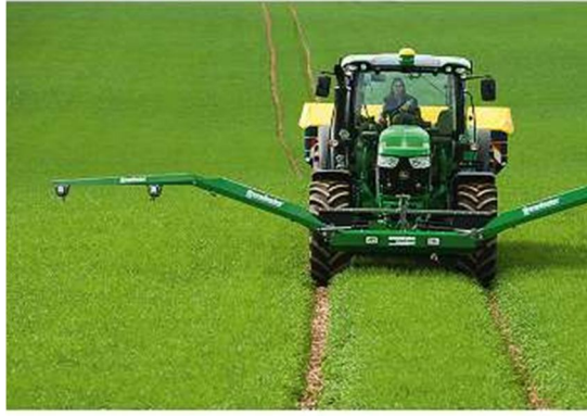
Рис. Розкидач мінеральних добрив (а) та датчик з системою GreenSeeker RT 200 (Засновані на використанні сенсорів системи варіабельного внесення)
