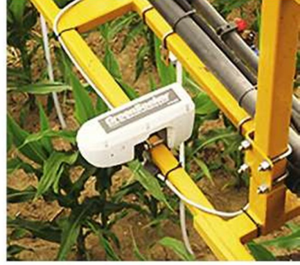
Рис. Розкидач мінеральних добрив (а) та датчик з системою GreenSeeker RT 200 (Засновані на використанні сенсорів системи варіабельного внесення)
