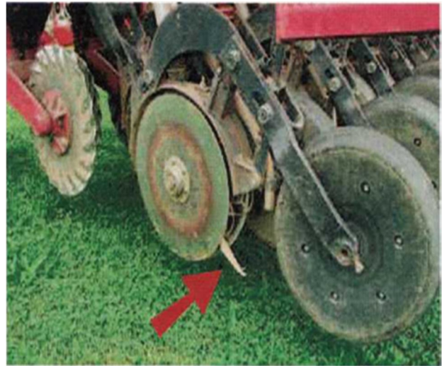
Ущільнювач насіння на сівалці прямого посіву заштовхує насіння в дно насінневої борозни.
