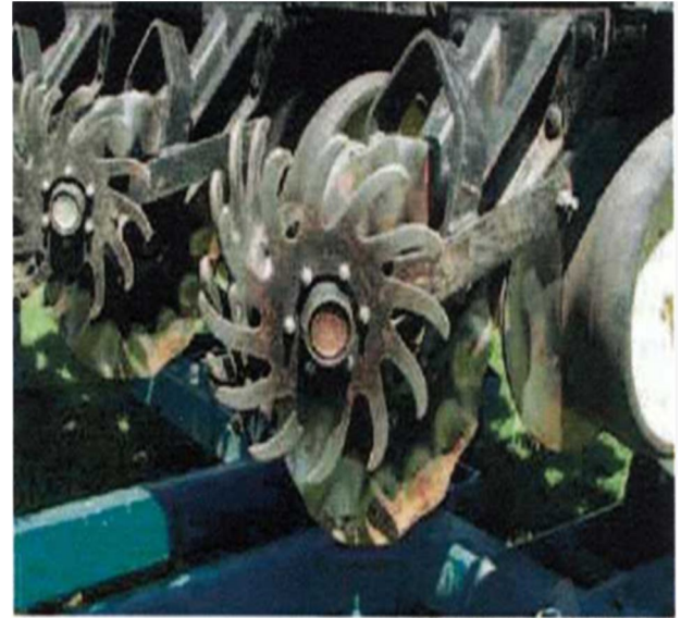
Рослинні залишки на очисниках рядків з заокругленими пальцями
