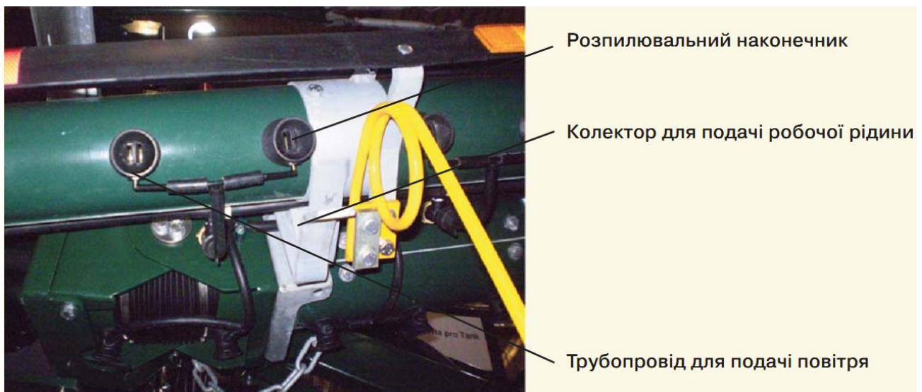
Рисунок 5.12. Пневмогідравлічні розпилювачі з примусовою подачею повітря
