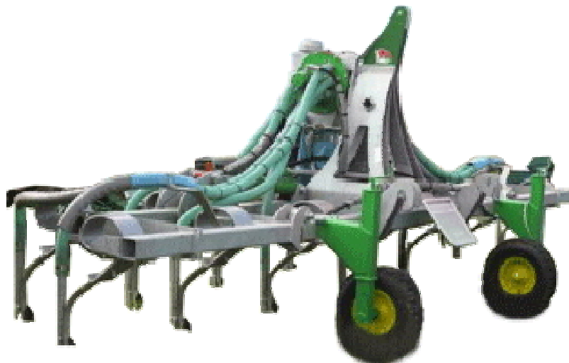
Рисунок 4.12. Адаптер для внутрішньогрунтового внесення добрив АВВ-6.
