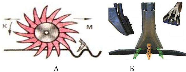
Рисунок 2.21. Інші поширені робочі органи комбінованих машин: А – голчасті диски; Б - підживлювальні лапи або ножі для сухого і рідинного підживлення.
