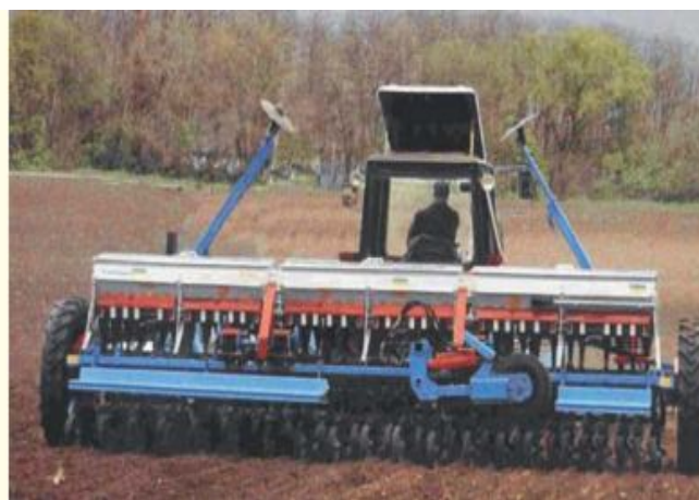
Рисунок 3.23. Загальний вигляд сівалок з дисковими сошниками: а) сівалки D9-AD3 фірми Амазоне обладнаної однодисковим сошником; б) сівалки СЗ-5,4 виробництва ВАТ «Червона зірка», обладнаної дводисковим сошником.
