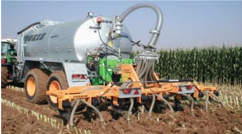
Рисунок 4.13. Цистерна для транспортування й внесення в ґрунт рідких органічних добрив Joskin.
