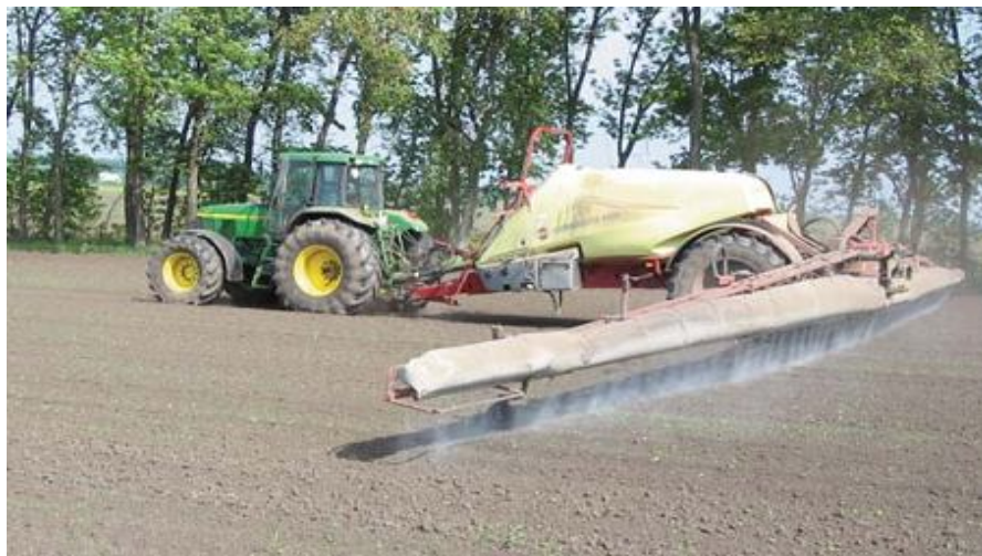
Рисунок 5.20. Система примусового осадження крапель: 1 - повітророзподільний рукав; 2 – вентилятор.
