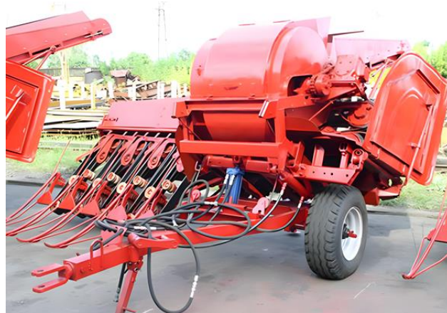
Рис. 9.4. Функціональна схема льонозбирального комбайна ЛКВ-4А: а – зв'язування стебел у снопи; б – розстилання стебел у стрічку; в – занальний вигляд льонозбирального комбайну ЛКВ-4А; 1 – щит для розстелення; 2 –
