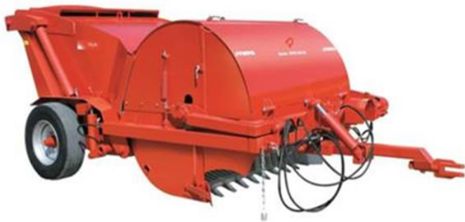
Рис. 14.6. Схема каменеприбиральної машини МУМ-205.
