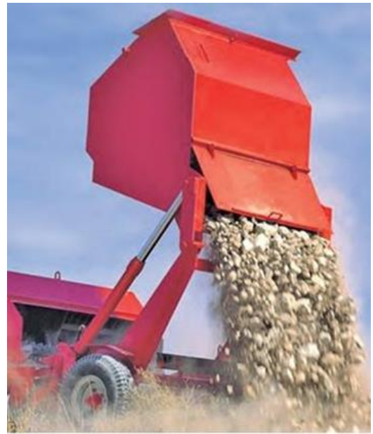
Рис. 14.6. Схема каменеприбиральної машини МУМ-205.
