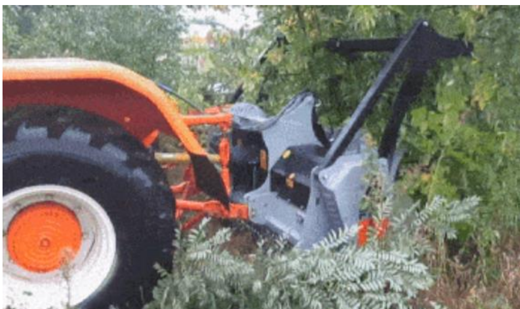
Рис. 14.3. Кущоріз фрезерний на базі трактора ХТЗ-150К
