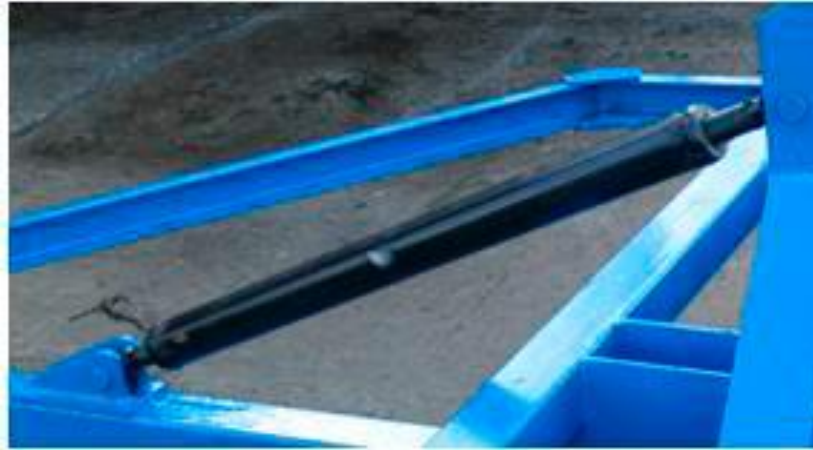
Рис. 3.9. Гвинтова телескопічна тяга.
