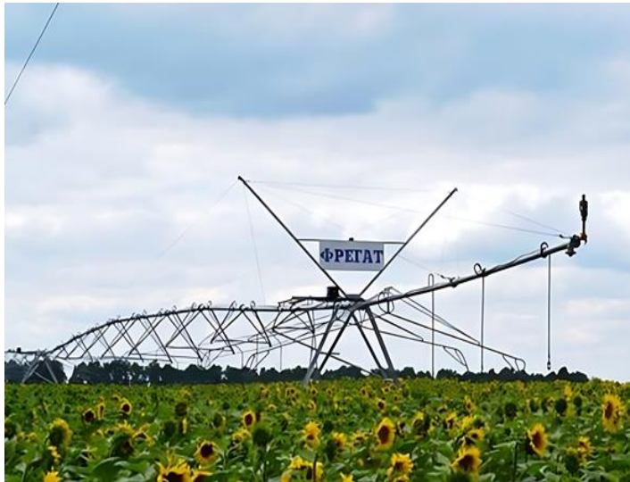
Рис.15.8. Дощувальна машина «Фрегат»: 1 – водопровідний трубопровід; 2 – дощувальні апарати; 3 – самохідна опора
