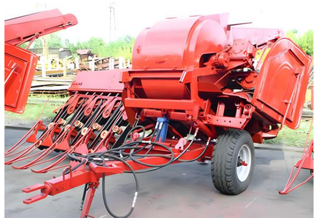
Рис. 9.4. Функціональна схема льонозбирального комбайна ЛКВ-4А: а – зв'язування стебел у снопи; б – розстилання стебел у стрічку; в – занальний вигляд льонозбирального комбайну ЛКВ-4А; 1 – щит для розстелення;
