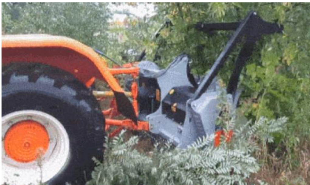
Рис. 14.3. Кущоріз фрезерний на базі трактора ХТЗ-150К
