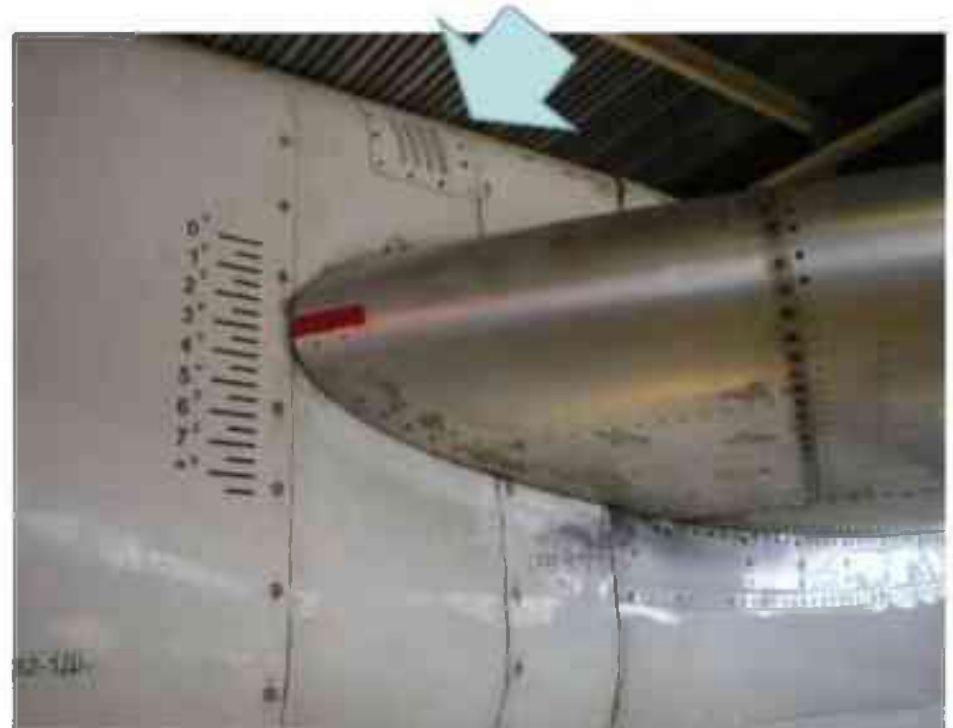
Приклад використання операції листового штампування надізання на конструктивному елементі фюзеляжа літака Ту-154
