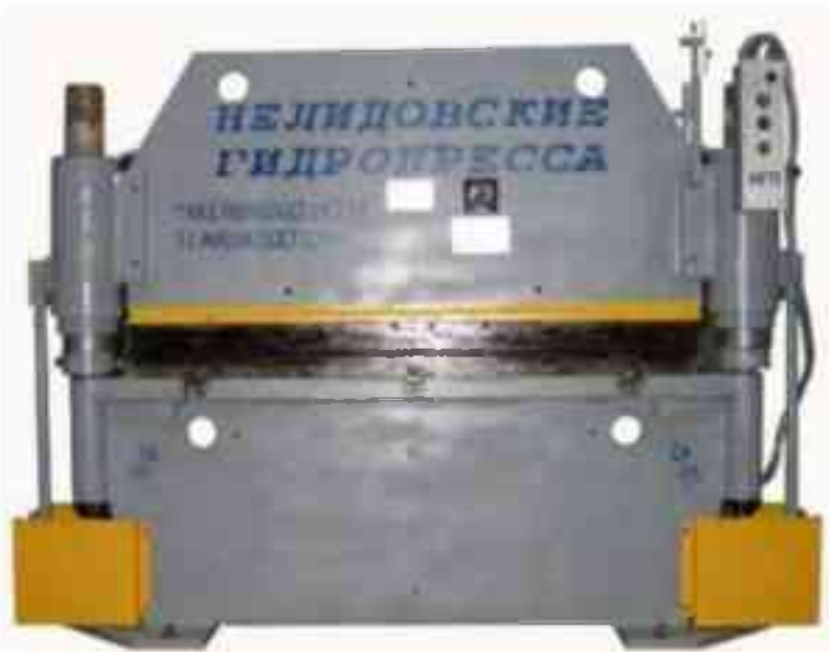
Загальний вид пресу для виконання операції відрізання – з паралельними ножами
