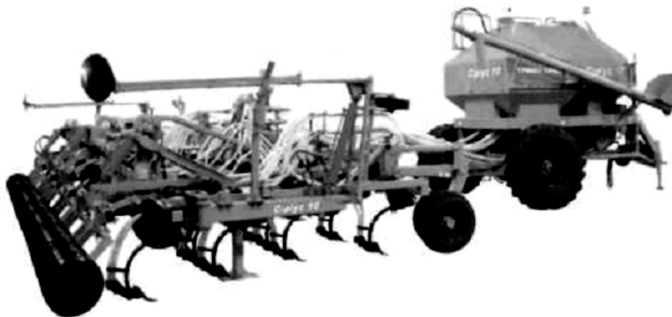
Рис. 8. Пневматична сівалка-культиватор Сіріус-10
