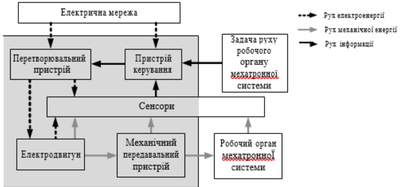
Рис. 1.18. Структура електроприводу у складі мехатронних систем
