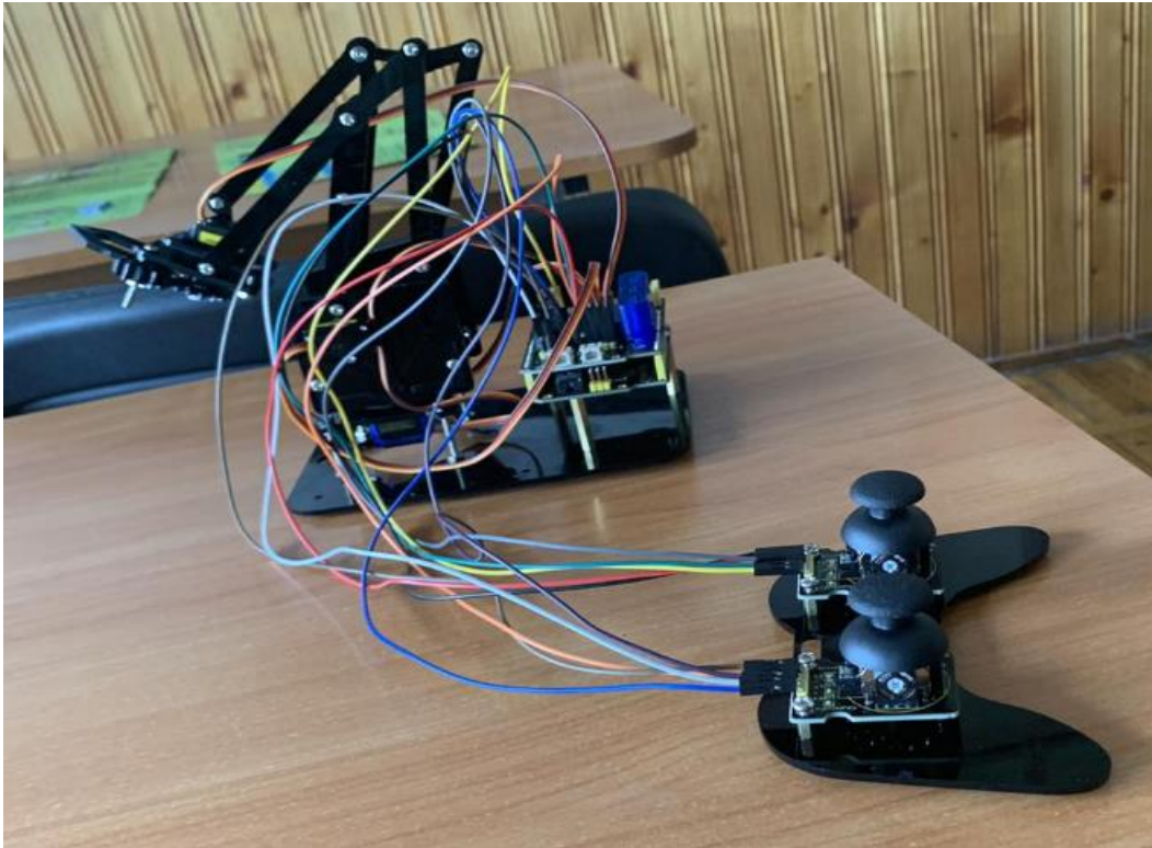
Рис. 3.4. Механічна частина ангулярного маніпулятора.
