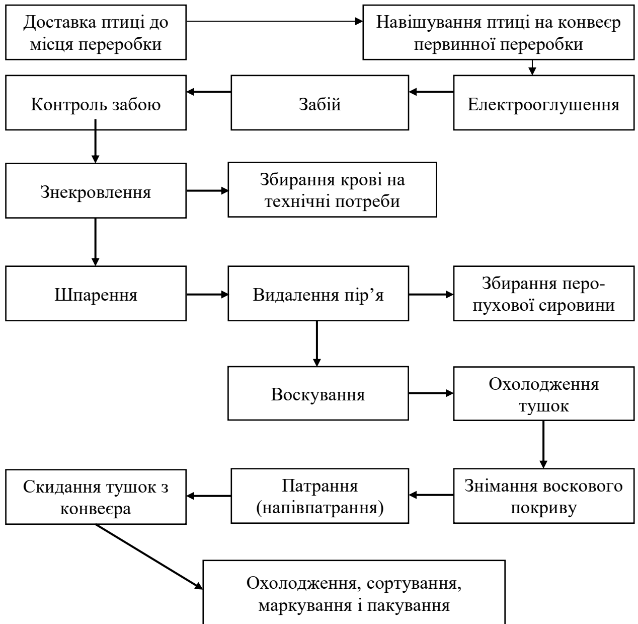
Рис. 7.7. Технологічна схема переробки птиці.
