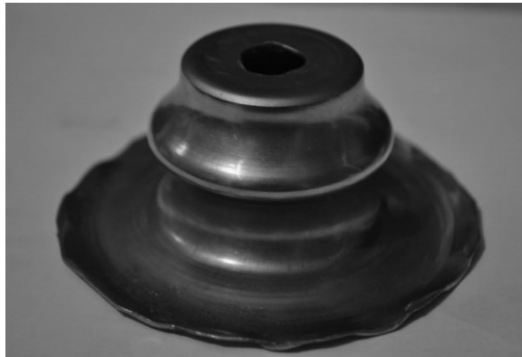
Рис. 8.4 - Деталь опукли-вігнутої форми з листової заготовки із сталі 10 та алюмінію АД1
