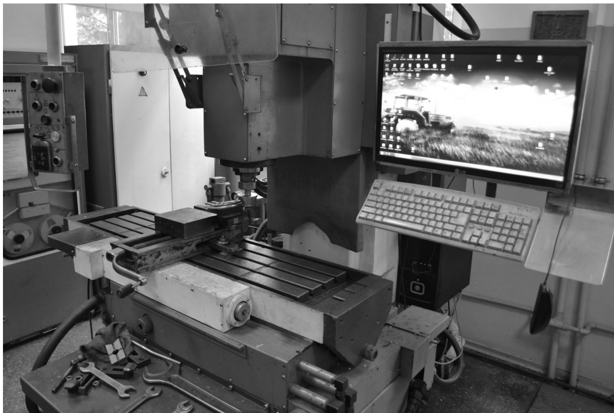
Рис. 8.1 - Фрезерний верстат з ЧПК із обладнанням для виготовлення вісесиметричних деталей
