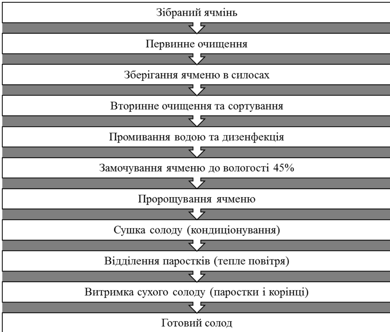
Рис. 1.4. Технологічна схема виробництва солоду
