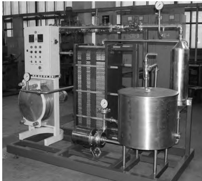
Рис. 3. Установка високотемпературної пастеризації вершків та жирових сумішей
