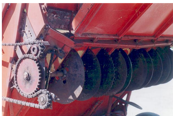
Рисунок 6 – Общий вид установленного на подборщике валков ПВ-6 дискового режущего механизма
