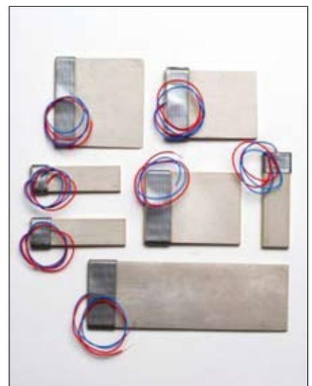
лу при малых (сотни микрон) отклонениях рабочей части. Однако американской компании APC International Inc. удалось создать и выйти на рынок с новым типом пластинчатого биморфа — «ленточным актюатором» (зарегистрированная торговая марка). Ленточный актюатор может обеспечивать блокирующую силу 0,95 Н и величину отклонения 1,2 мм или отклонение до 3 мм и блокирующую силу 0,6 Н.
