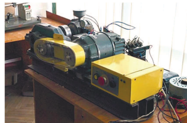
Рис.1. Лабораторний стенд дослідження характеристик двигуна постійного струму змішаного збудження
