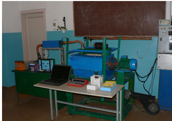
Рис. 4. Комплекс дослідження процесу вібраційно-фільтраційно-конвективного сушіння високовологого насіння гарбуза
