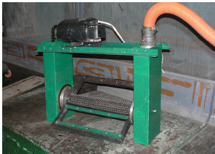
Рис. 5. Пристрій фільтраційного волого видалення, перемішування та очистки перфорованих поверхонь
