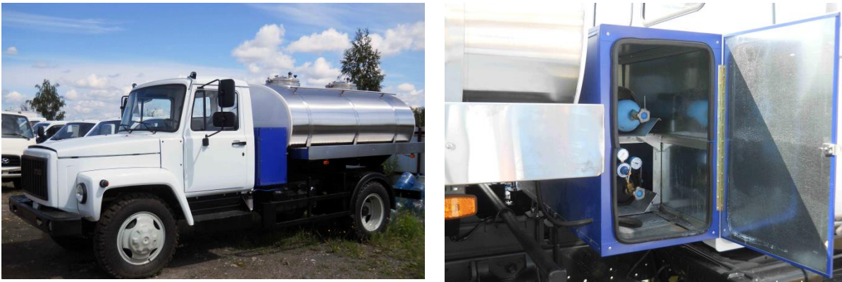
Рис.8.4. Автомобіль ГАЗ, обладнаний автоцистерною та системою подачі кисню
