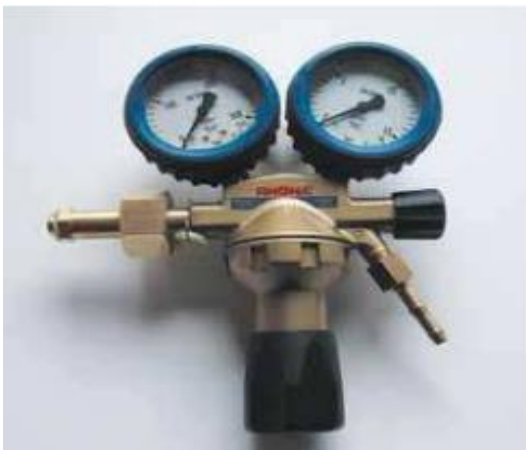
Рис 8.9. Додаткове обладнання для контролю умов перевезення: а – кисневий редуктор; б – ротаметр
