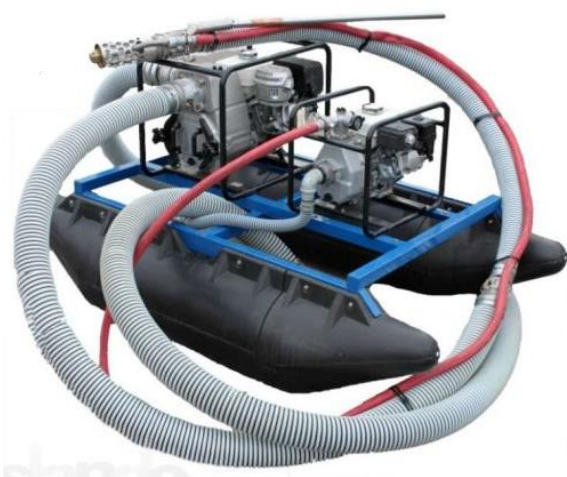
Рис. 1.2.1.10. Міні земснаряд Piranha (США) модель PS-165-E
