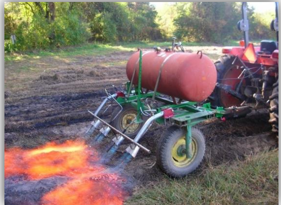
Рис. 1.2.5.1. Схема та загальний вигляд вогневого культиватора
