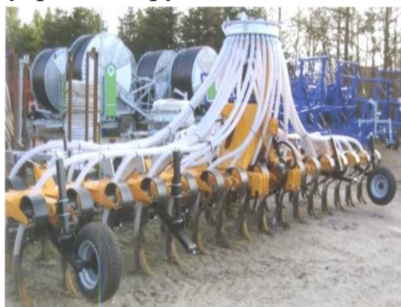
Рис. 1.2.3.4.1. Агрегат для внутрішньо-ґрунтового внесення рідких добрив
