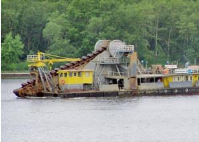
Рис. 1.2.1.6. Плаваюча землевсмоктуюча установка з багаточерпаковим пристроєм
