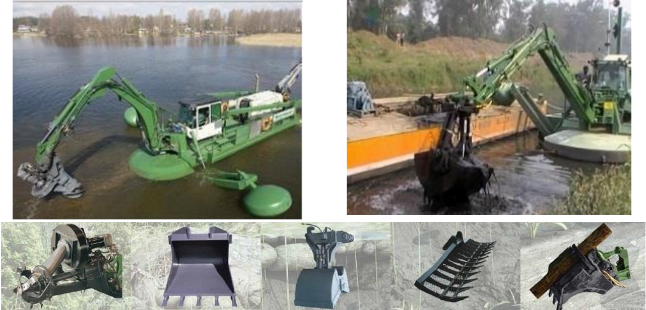
Рис. 1.2.1.11. Земснаряд Watermaster та його змінні робочі органи
