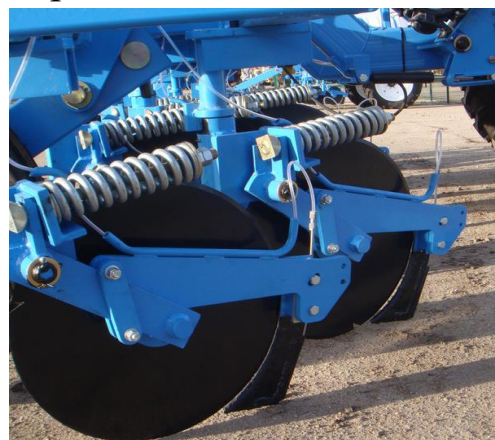
Рис. 1.2.3.4.1. Агрегат для внутрішньо-ґрунтового внесення рідких добрив
