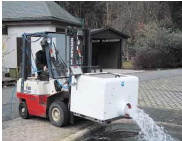
Рис. 8.12. а – завантаження риби на трейлер, б – розвантаження контейнера безпосередньо у водойму
