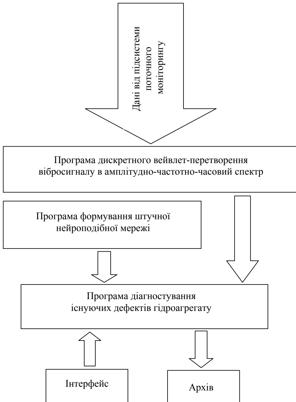
Рисунок 3.1 – Структура підсистеми діагностування існуючих дефектів
