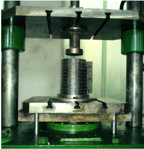
Рисунок 6.2 – Фотографія технологічного оснащення експериментального гідроімпульсного стенду для попереднього віброударного зневоднення
