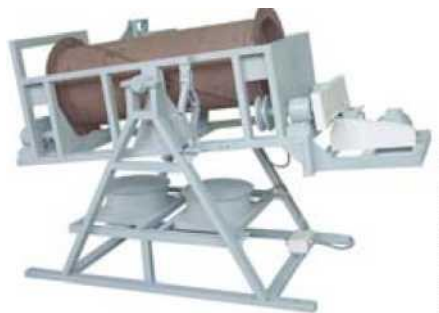
Рис. 4.7. Барабанна тупикова поворотна електропіч ПБТ 4,9/4
