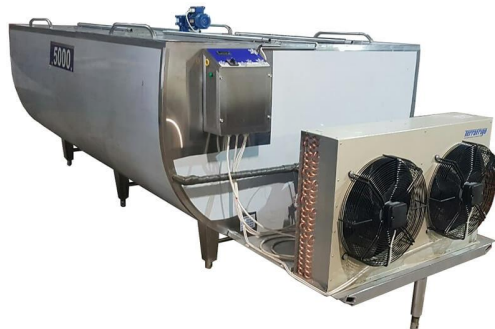
Рис. 7.2. Загальний вигляд резервуара-охолодника молока МКА-2000Л-2А
