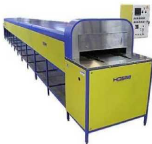
Рис. 4.5. Електропіч конвеєрна моделі ПКМ-5/3
