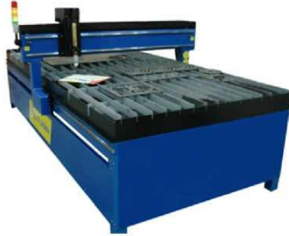
Рис. 10.4 Металооброблювальний верстат плазмового різання з ЧПК «АртПлазма»
