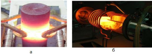
Рис. 8.1. Об'єкт нагрівання індукційним електричним полем
