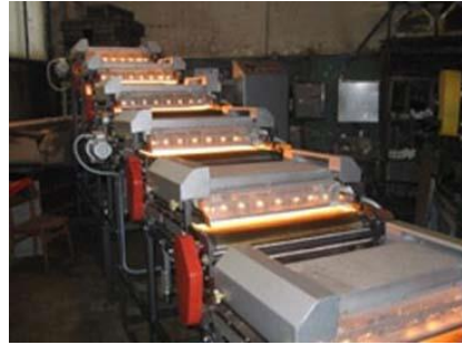
Рис. 6.5. Загальний вигляд установки для сушіння зерна ІЧ променями а – барабанного, б – решітного типу
