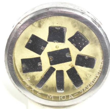
Розрізані зразки після осадки до різного ступеня деформації для виміру твердості по Віккерсу HV
