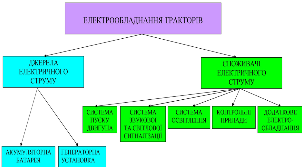
Рис. 9.1. Схема класифікації електрообладнання тракторів
