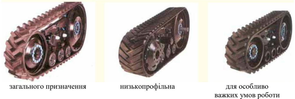
Рис. 11.9. Типи гусениць, які встановлюють на трактори «Challenger» серії МТ 700
