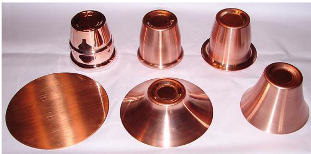
Рисунок 1.17 – Деталі, що виготовляються ротаційною витяжкою
