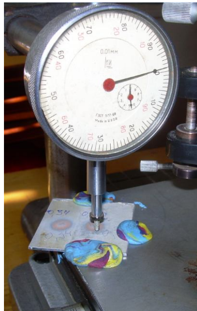
Рисунок 3 - Вимірювання висоти профіля фігури напилення
