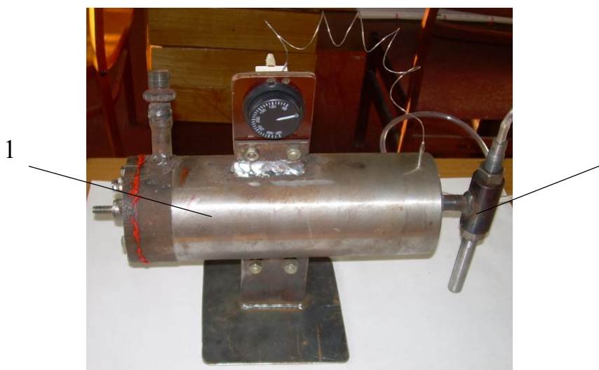
Рисунок 1 – Дослідна установка для газодинамічного нанесення функціональних покриттів. 1 – нагрівач повітря. 2 – розпилювач порошку
