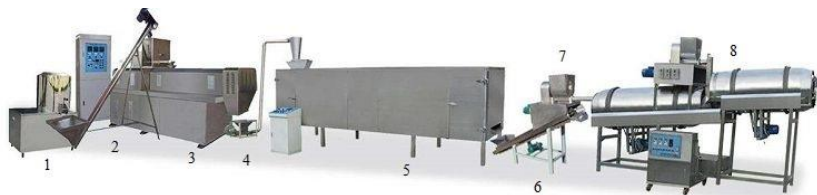
Рис. 3. Технологічна лінія виробництва кукурудзяних снєків: 1 - змішувач; 2 - шнековий конвеєр; 3 - екструдер; 4 - повітряний транспортер; 5 - сушарка; 6 - транспортер; 7 - обприскувач; 8 - охолоджувач
