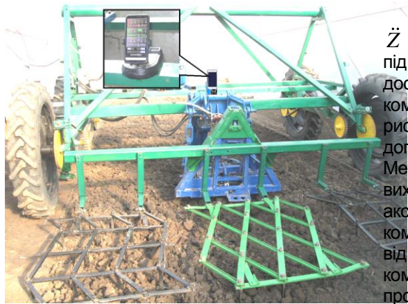
Рис. 4. Спеціалізований ширококоліїний агрозасіб зі встановленим планшетним комп'ютером
