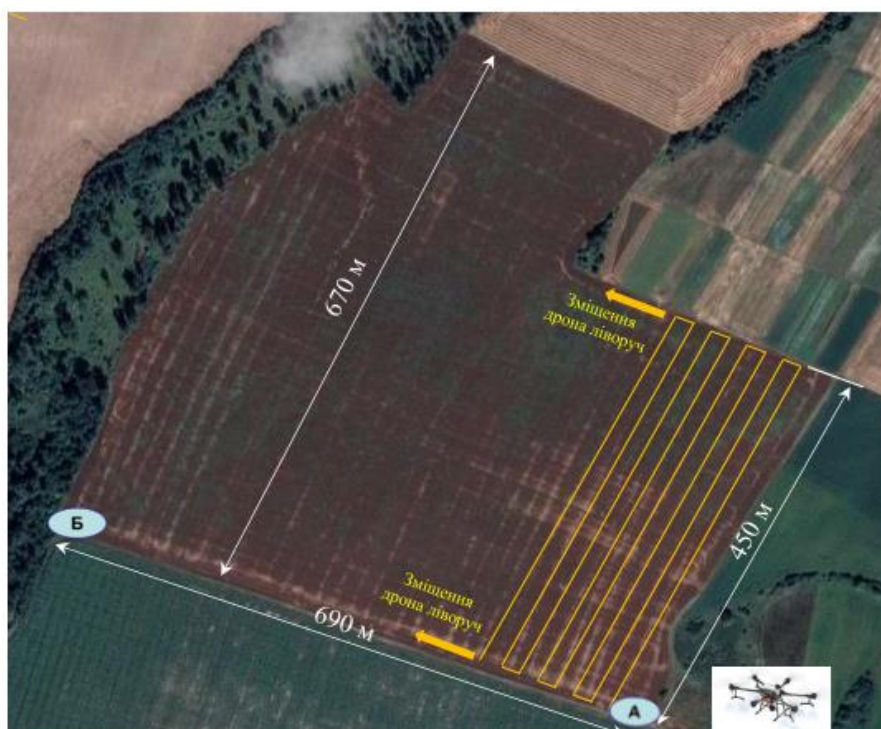
Рис. 1. Схема робочої ділянки для визначення продуктивності Agrass T16
