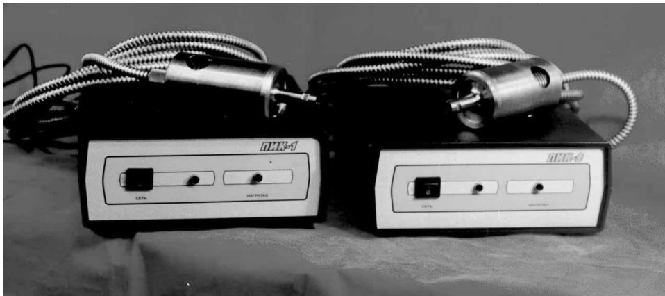
Рисунок 4.15 – Комплекти ультразвукової апаратури “Пік-1” та “Пік-2” для відбивання накипу на теплообмінних поверхнях
