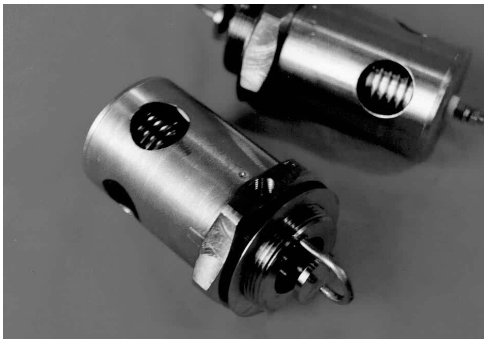
Рисунок 4.4 – Диспергатори для розпилення води в тонкому шарі на частоті 22 кГц, що забезпечують продуктивність 0,63 л/хв
