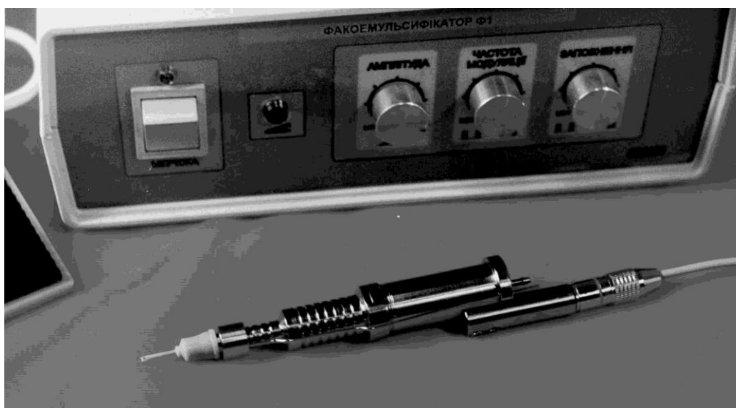
Рисунок'4.42 – Ультразвуковий факоемульсифікатор для виконання офтальмологічних операцій
