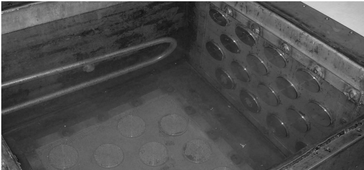
Рисунок 4.23 – Приклади розміщення ультразвукових перетворювачів на донній та бокових поверхнях ванни
