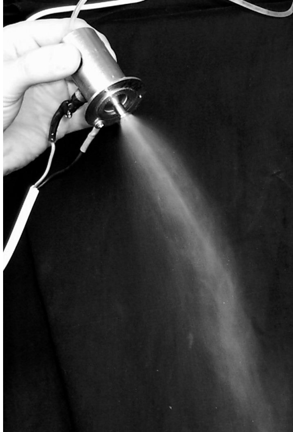
Рисунок 4.20 – Процес ультразвукового розпилення води одним з диспергаторів багатоточкової системи в термічну камеру обладнання для виробництва ковбасної продукції
