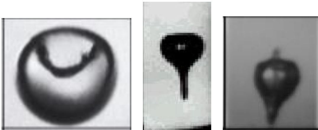
Рисунок 1.2 – Симетричний характер зміни сферичності форми кавітаційної бульбашки при схлопуванні поблизу “твердої” стінки
