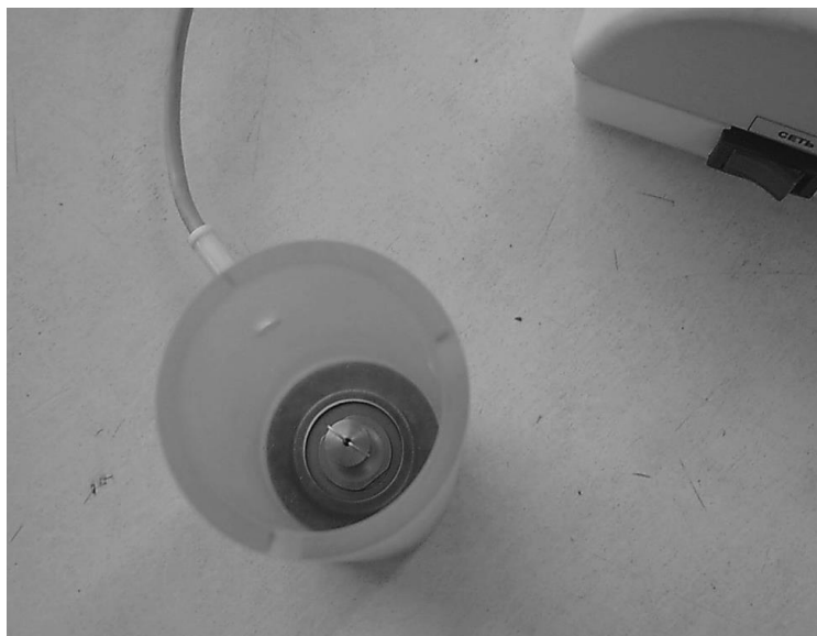
Рисунок 4.43 – Ультразвукові медичні інгалятори з розпиленням в тонкому шарі та дозованим постачанням аерозолію
