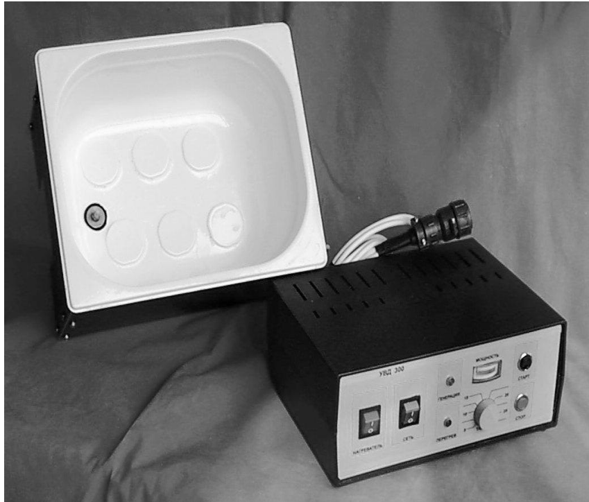
Рисунок 2.4 – Ультразвукова ванна для очищення великогабаритних деталей об'ємом 6 літрів
