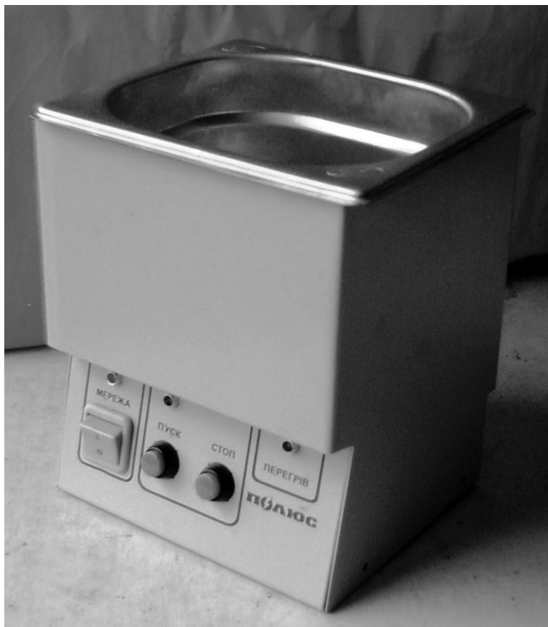
Рисунок 2.3 – Малогабаритна ультразвукова ванна об'ємом 1 літр
