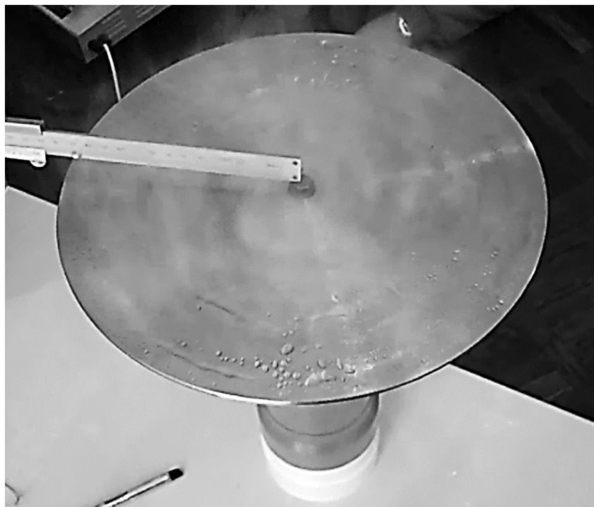
Рисунок 4.40 – Випромiнювання профiльованим дисковим вiбратором хвилi з плоским фронтом
