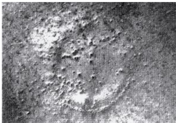
Рисунок 1.20 – Тіньова фотографія кавітаційної ерозії алюмінієвої фольги при схлопуванні ста бульбашок
