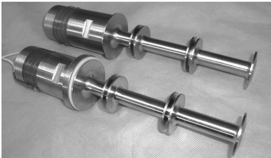
Рисунок 4.24 – Ультразвукові приводи поздовжніх переміщень з розвиненою поверхнею випромінювання
