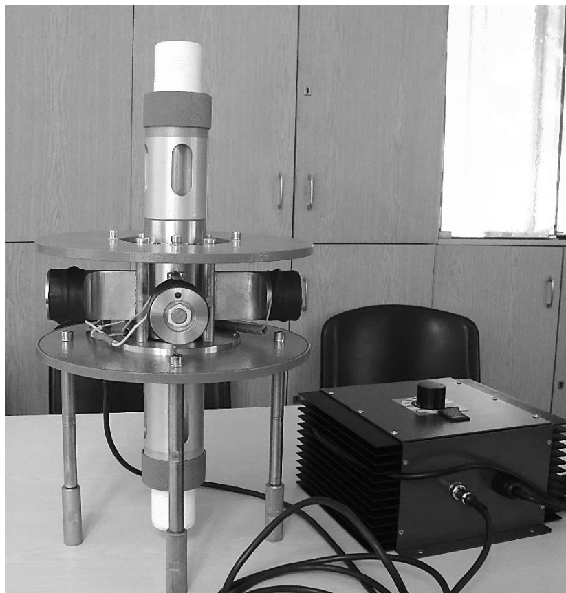
Рисунок 4.36 – Ультразвукове кавітаційне обладнання для отримання особливо чистих екстрактів лікарських рослин
