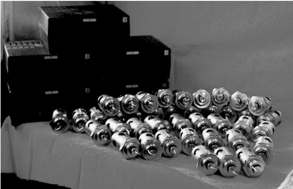
Рисунок 4.3 – Система ультразвукового розпилення води продуктивністю 25 л/хв
