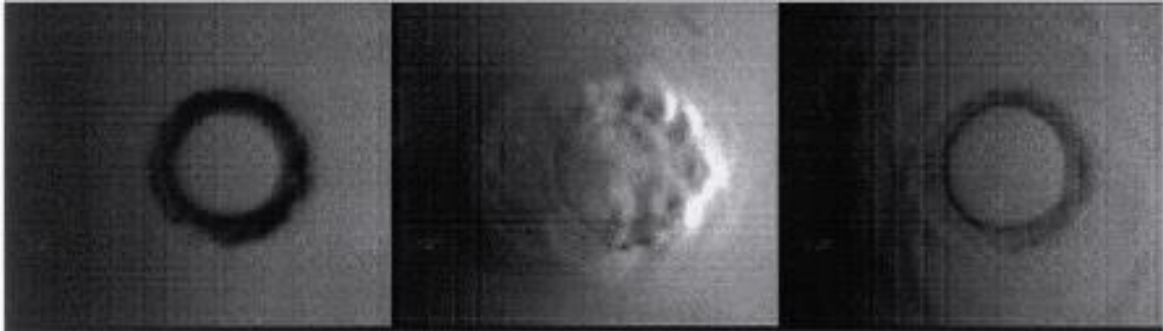
Рисунок 1.19 – Вид зверху на останні стадії існування бульбашки. Спостерігається утворення ударних хвиль та наслідки кавітаційної ерозії. Швидкість зйомки 1 млн. кадрів за секунду.
