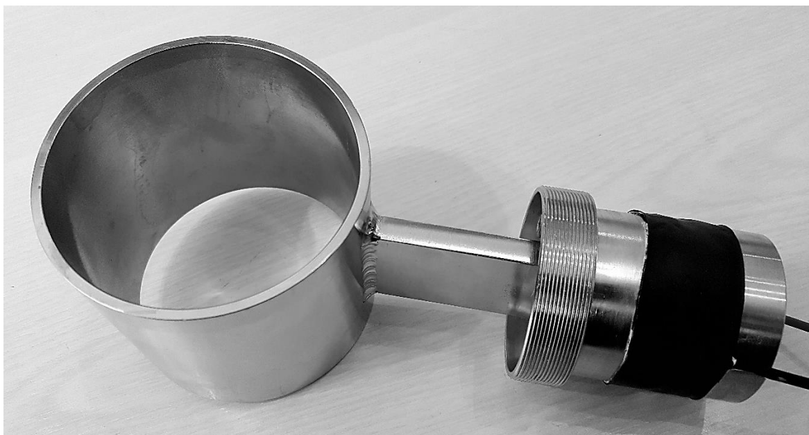
Рисунок 4.29 – Ультразвуковий розпилювач з трубчастою циліндричною поверхнею випромінювання та 1/2 - хвильовим ультразвуковим складеним резонансним приводом поздовжніх переміщень
