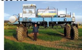
Рис. 1. Світові моделі ширококоліїних (мостових) транспортних засобів (wide span vehicle gantry)
