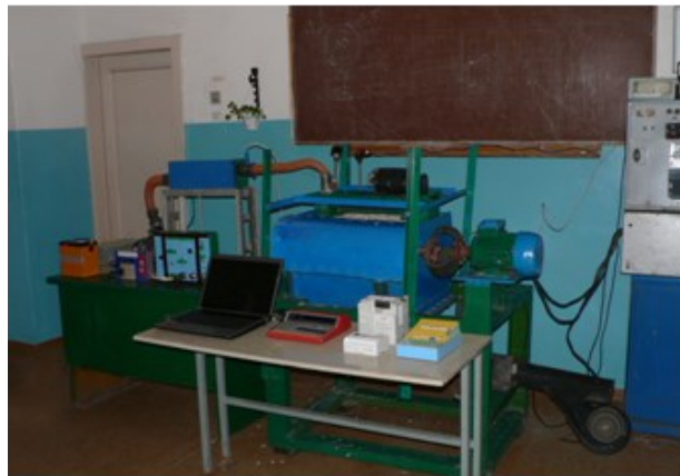
Рис. 8. Загальний вигляд вібраційної установки для фільтраційно-конвективного сушіння насіння гарбуза
