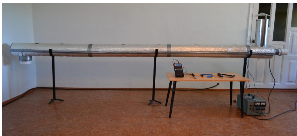
Рис. 3. Загальний вигляд експериментального зразка тритрубного концентричного теплообмінника
