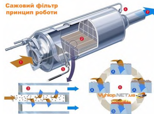
Рис. 3. Схематичний принцип роботи сажового фільтра [9]:
