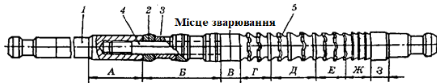
Рис. 3. Деформуюче-різальна протяжка: передня направляюча – А; деформуюча секція – Б; проміжна направляюча – В; чорнова – Г; допоміжна – Д; чистова – Е; калібруюча – Ж частина різальної секції 5; задня направляюча – З
