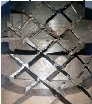
Рис. 14. Фрагмент макрорельєфу, одержаний на гільзі ( d = 50 мм; L = 500 мм) із алюмінієвого сплаву АК-6 ( \sigma_B = 270 МПа; \sigma_{0,2} = 160 МПа; \delta = 13\% ) комбінованою протяжкою з гвинтовими рельєфоутворювальними елементами. Характеристики ПРМ: h = 1,5 мм; axb = 18 \times 18 мм; \eta = 45^\circ ; 2\phi = 60^\circ ; r = 0,1 мм; T_p = 92\%
