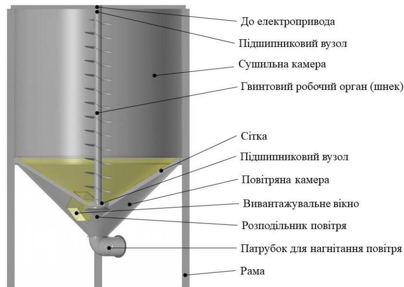
Рис. 1. Конструктивно-технологічна схема конвективної сушарки волоських горіхів
