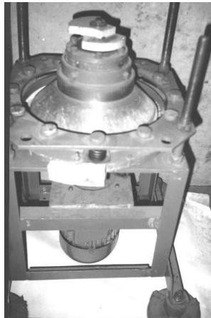
Малюнок 5.60 - Зовнішній вигляд конічного мелючого тіла із дебалансним валом, що встановлені на рамі за допомогою пружних елементів
