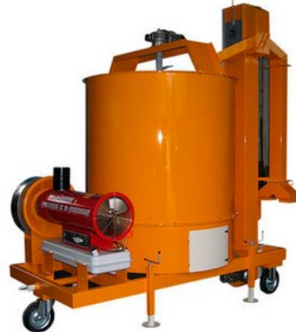
Рис. 3. Колісна моноблочна сушарка для волоських горіхів Rivmes (Італія)
