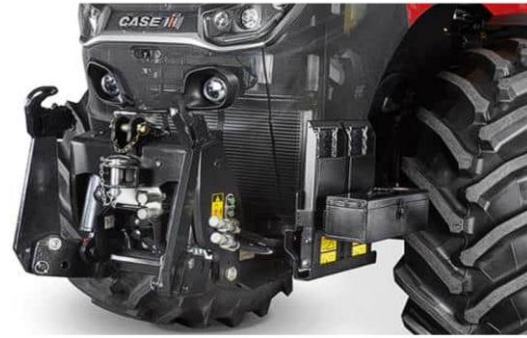
Рис. 6. Передній навісний пристрій
