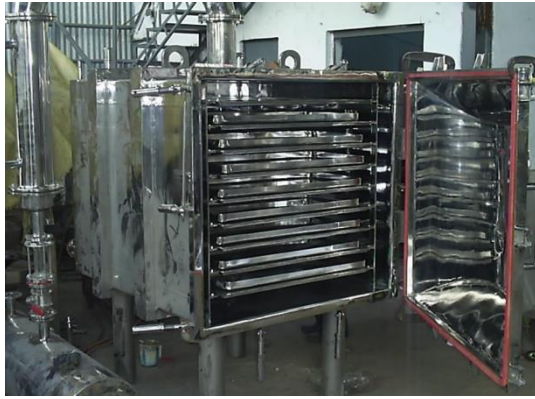
Рис. 9. Загальний вигляд (a) і конструктивно-технологічна схема (b) вакуумної сушарки [22]
