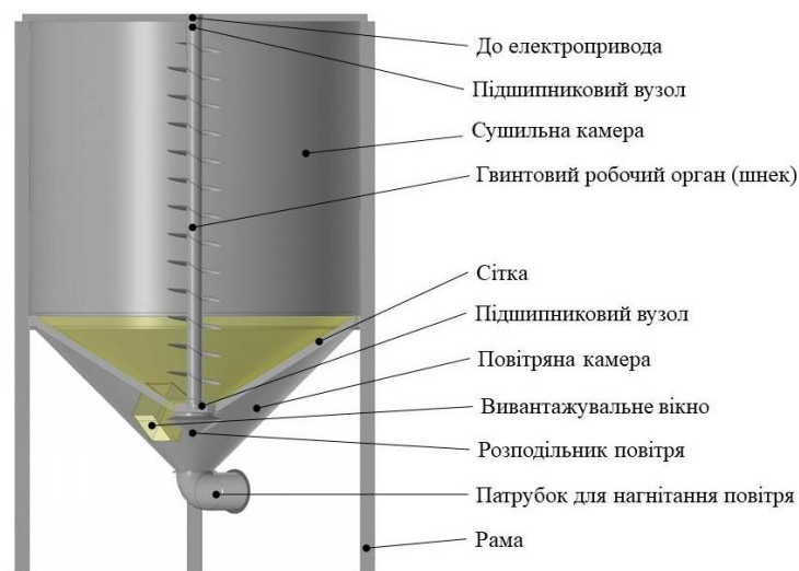
Рис. 12. Конструктивно-технологічна схема конвективної сушарки волоських горіхів [25]
