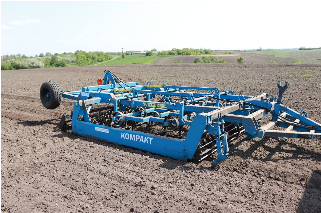
Рис. 1. Загальний вигляд комбінованого агрегату для передпосівного обробітку ґрунту ВАТ «Хмільниксільмаш»
