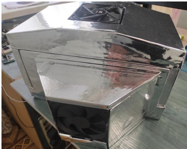
Рис. 3. Схема (а) і загальний вигляд (б) лабораторного стенду для дослідження теплообмінника побічно-випарного типу
