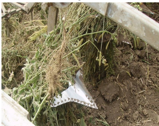
Рис. 4. Забивання рослинними рештками серійних робочих органів
