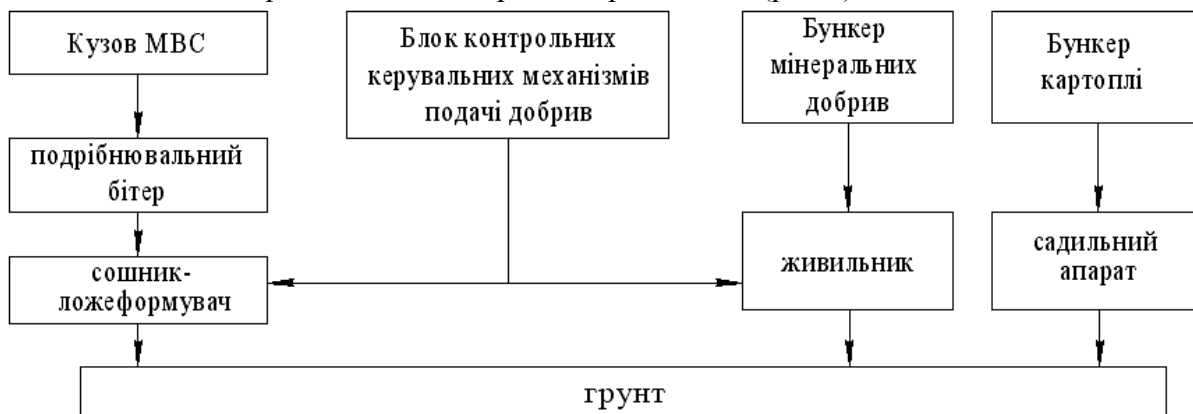
Рис. 3. Структурна схема засобу локального внесення органічно-мінеральних добрив при посадці картоплі
