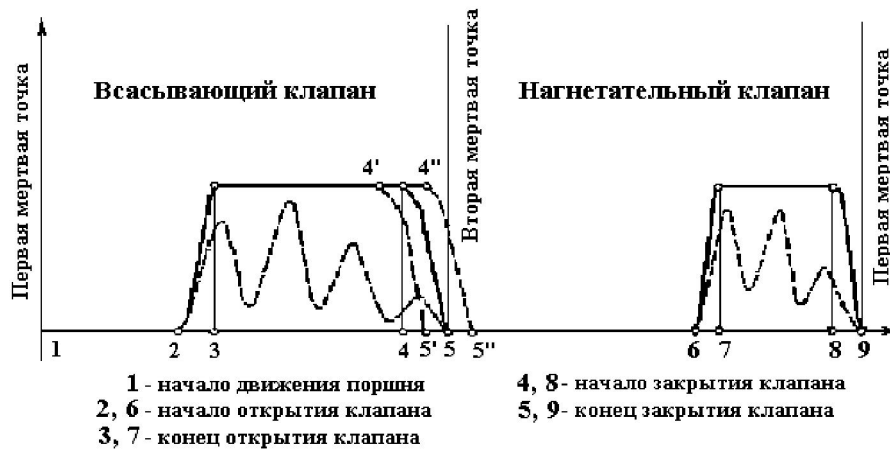
Рис. 2. Діаграма руху закриваючих органів клапана (робоче вікно програмного забезпечення)
