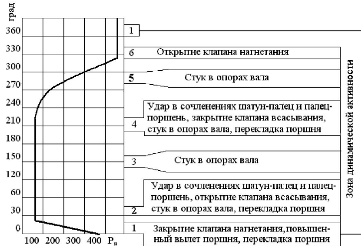
Рис. 3. Діаграма роботи поршневого компресора з однією порожниною нагнітання (робоче вікно програмного забезпечення)
