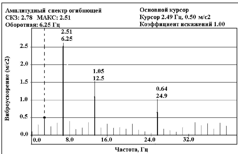
Рис. 7. Спектр огинаючої вібросигналу несправного клапана (робоче вікно програмного забезпечення)
