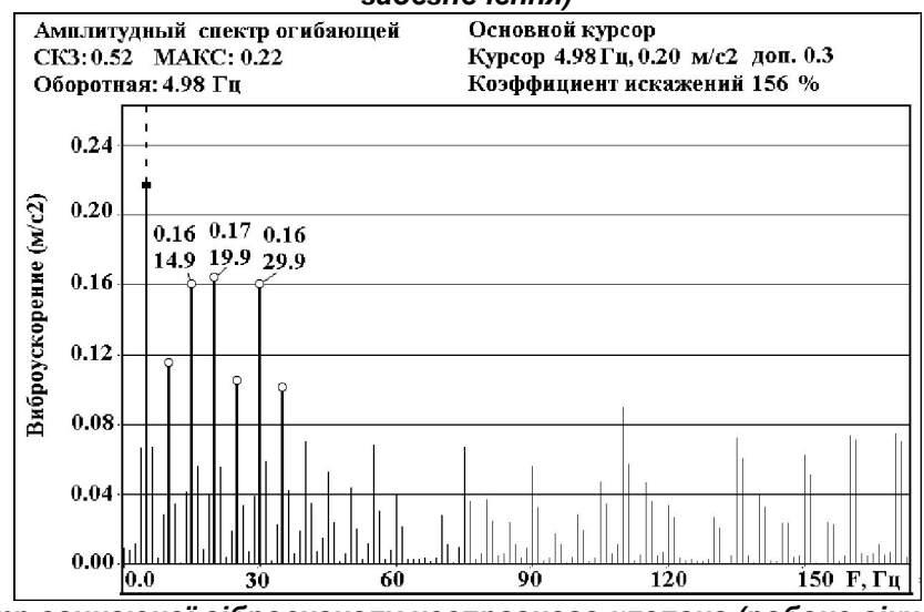
Рис. 13. Спектр огинаючої вібросигналу несправного клапана (робоче вікно програмного забезпечення)
