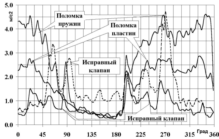
Рис. 6. Вібросигнали з справних і несправних клапанів клапанов (робоче вікно програмного забезпечення)
